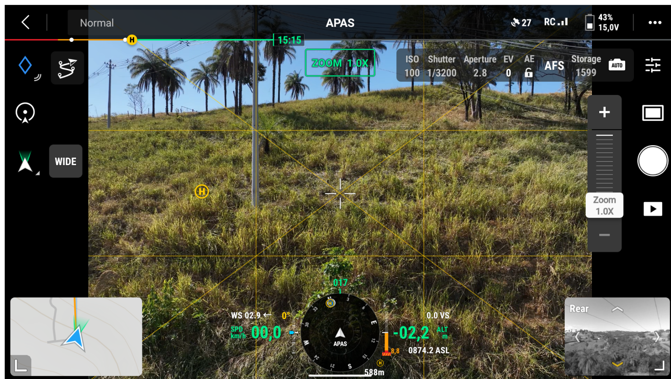
Figura 07 - Verificando alinhamento do poste com a linha de grade da câmera
